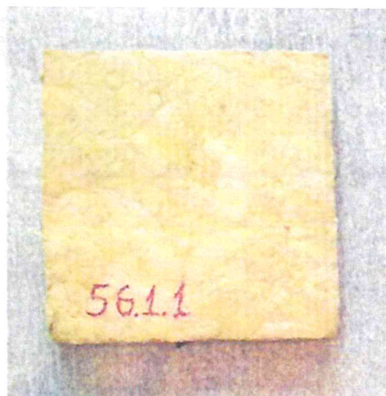
Рис. 6. Вид образца Шуманет-БМ до (слева) и после (справа) прохождения 100 циклов замораживания и оттаивания
