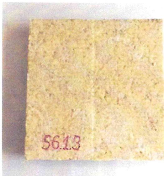
Рис. 5. Вид образца Шуманет-БМ до (слева) и после (справа) прохождения 60 циклов замораживания и оттаивания
