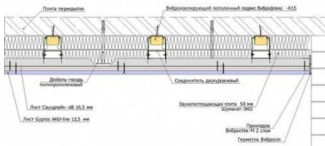
Конструкция состоит из металлического двухуровневого каркаса, виброизолирующих подвесов Виброфлекс-К15, двух слоев звукопоглощающей плиты Шуманет-Эко, акустического триплекса Саундлайн-dB и обшивных листов Гуркос АКУ-line.
