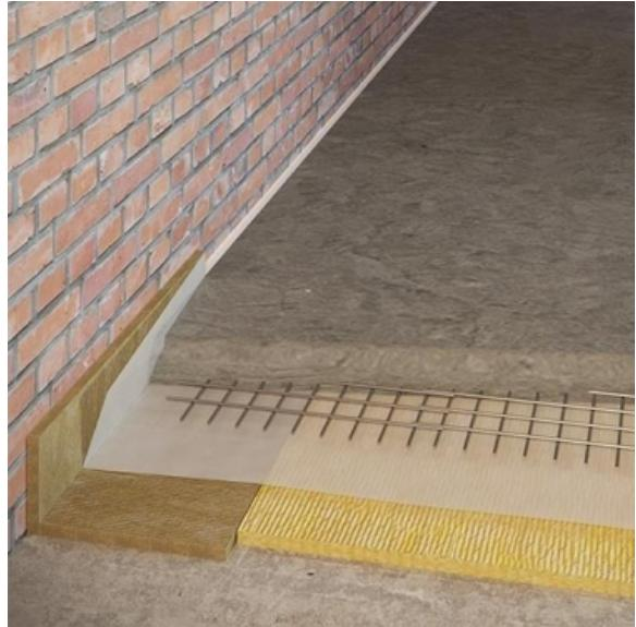
**Площадь: 13 м<sup>2</sup>****Толщина конструкции: 80 мм****ΔRw \* ~ 8-10 дБ**
